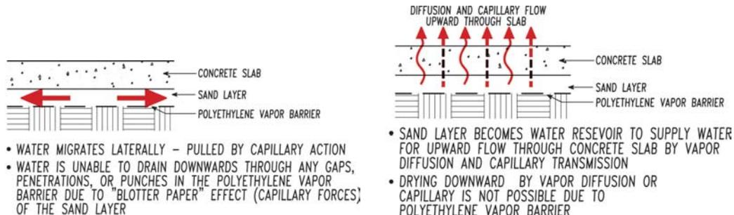
FIG. 2 WATER DISTRIBUTION IN SAND LAYER
